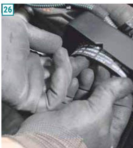
26) Com todas as indicações feitas, e o material novo em mãos, encaixe a nova correia dentada no local. Na sequência inicie o processo de montagem, trocando a correia de acessórios, correia dentada, e o tensionador.
