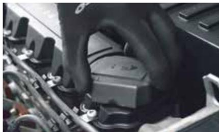
**11)** Dê a partida no motor sem acelerar para encher o filtro com lubrificante. Verifique se a luz de advertência da pressão de óleo no painel se apaga em, no máximo, 10 segundos. Após a luz de advertência apagar, desligar o motor, aguarde alguns instantes e meça novamente o nível do cárter com a vareta. Se não apagar, desligar o motor imediatamente para averiguações.
