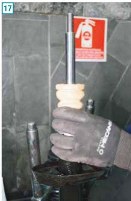
17) Para montar o novo conjunto, comece instalando o batente.
