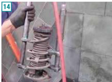
15) Remova a porca de fixação, arruela e o coxim com o rolamento. Remova ainda o prato de mola. Neste carro, somente as porcas de fixação e arruelas serão reaproveitadas na instalação do novo componente.
