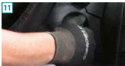
**Obs:** Após alguns minutos, verifique se há vazamento do óleo na região da vedação do filtro. Se houver, reaperte o necessário. Caso o vazamento persista, remova o filtro e verifique novamente a área de vedação e em seguida reinstale o filtro, se possível.
