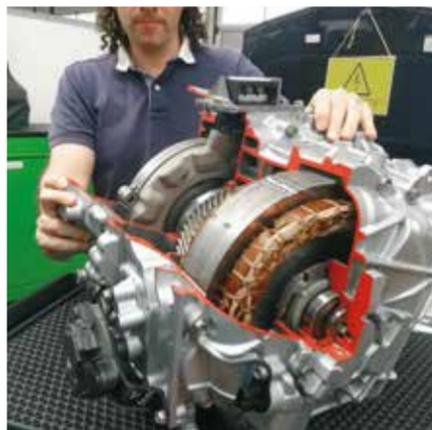
res também possuem dimensões diferentes. O motor-gerador 1, mais próximo ao motor a combustão, é menor e se encarrega mais da tarefa de geração de energia que o motor-gerador 2, que é maior e fica mais a cargo da propulsão do veículo quando em modo de condução totalmente elétrico. Diego, da Bosch, pondera que apesar dessa diferença “nada impede que os dois motores-geradores se encarreguem da propulsão ao mesmo tempo ou que ambos regenerem energia para abastecer a bateria ao mesmo tempo”.
