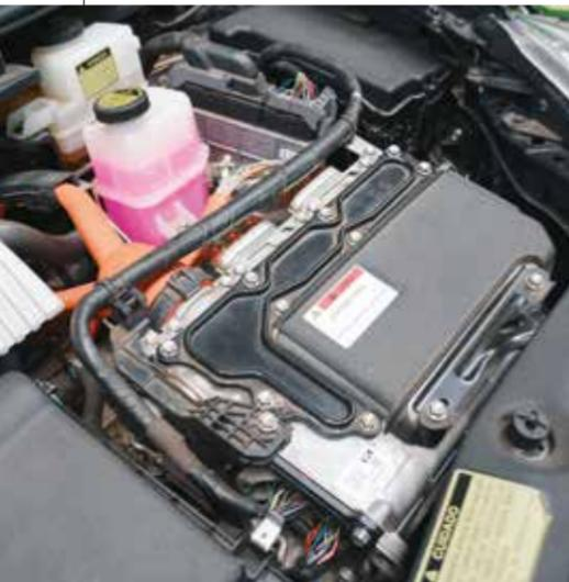
O inversor/conversor tem que controlar etapas de potência com tensões e correntes muito elevadas, por isso, é uma peça pesada e robusta. Como a geração de calor também é alta, tanto o inversor/
