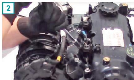
3) Utilizando a mesma chave de 10 mm, solte o coletor de aspiração.
