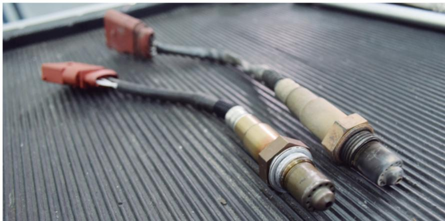
trica, ou seja, a proporção ideal entre ar e combustível para uma queima perfeita dentro dos cilindros. Analisando por osciloscópio, percebe-se que o sinal da sonda oscila continuamente entre mistura rica e pobre, formando uma onda cujos picos e vales têm um desenho parecido com a letra lambda do alfabeto grego ( $\lambda$ ) – daí vem o nome desse componente.
