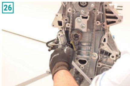
**27)** Com a mesma chave torx T45, fazer a retirada da polia de bomba d'água
