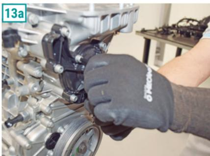
**13)** Retire a tampa de bomba d'água com uma chave allen 5 mm **(13a)**, ao todo são 7 parafusos. **(13b)**
