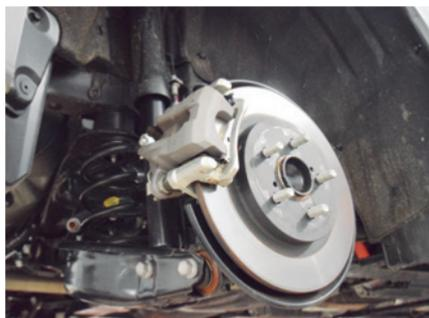
na dianteira e Double Wishbone na traseira. “As suspensões são semelhantes as do Toyota Prius, porém os amortecedores têm calibração específica para os modelos Lexus. No caso do CT 200h, a configuração privilegia a esportividade. Os outros itens que compõem o sistema como bandejas, pivôs e bieletas, são simples de substituir e não exigem ferramentas especiais”, indica o proprietário da Five’s Garage.
