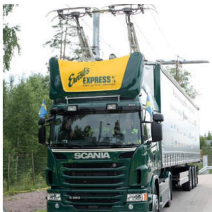
Scania eletrificado que utiliza rede externa para recarregar a bateria
