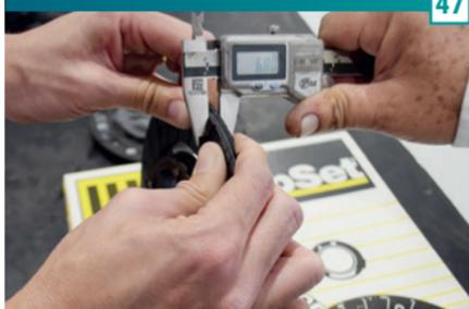
47) Utilize o Dinamômetro para realizar novamente o teste da força de acionamento do pedal de embreagem. Após a instalação do conjunto novo o resultado foi de 8,6 kgfm contra 11,1 kgfm do conjunto antigo devido ao desgaste da espessura do disco. Aliás, a medição do disco antigo aferido foi de 6,80 mm, enquanto o novo 7,60 mm. Essa diferença de 0,80 mm muda a força aplicada no pedal de embreagem.
