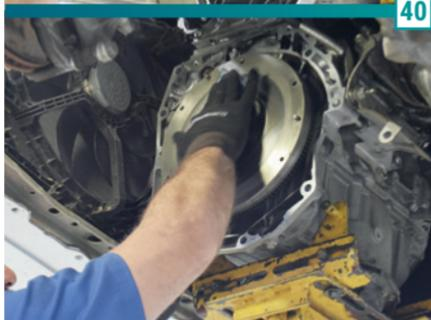
**41)** Utilize uma ferramenta centralizadora para centralizar o disco. Realize o aperto em cruz dos seis parafusos sextavados de 12 mm (torque de 3 Nm).
