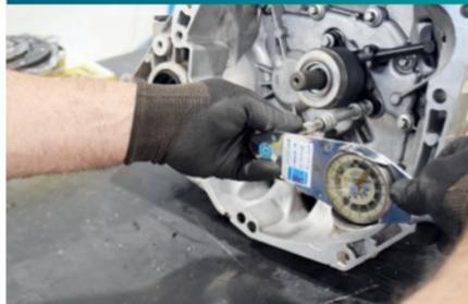
**37) DICA:** Antes da montagem do atuador hidráulico siga um procedimento simples que ajuda na hora da sangria. Acione e segure o atuador. Após utilize uma seringa para preencher o cilindro e volte gradativamente o atuador. Faça esse procedimento por duas e três vezes ou até perceber que não existem mais bolhas de ar no sistema. O fluido utilizado no March é DOT4.
